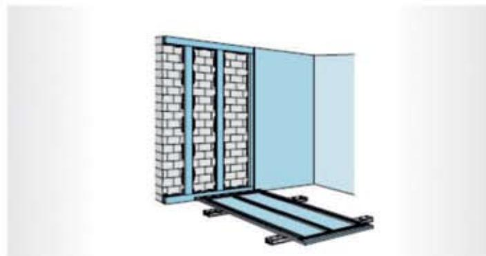
**Облицовка методом приклеивания** применяется в том случае, если существующие основания достаточно прочные и относительно ровные (отклонения от плоскости – не более 30 мм). В качестве клея используются гипсовые составы Knauf Perlfix либо Knauf Fugenfüller.
