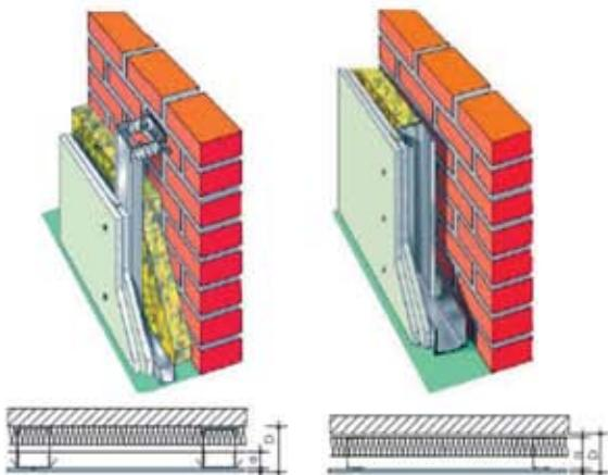
**Монтаж облицовки из листов Knauf на клей Knauf Fugenfüller (для ровных оснований).**
